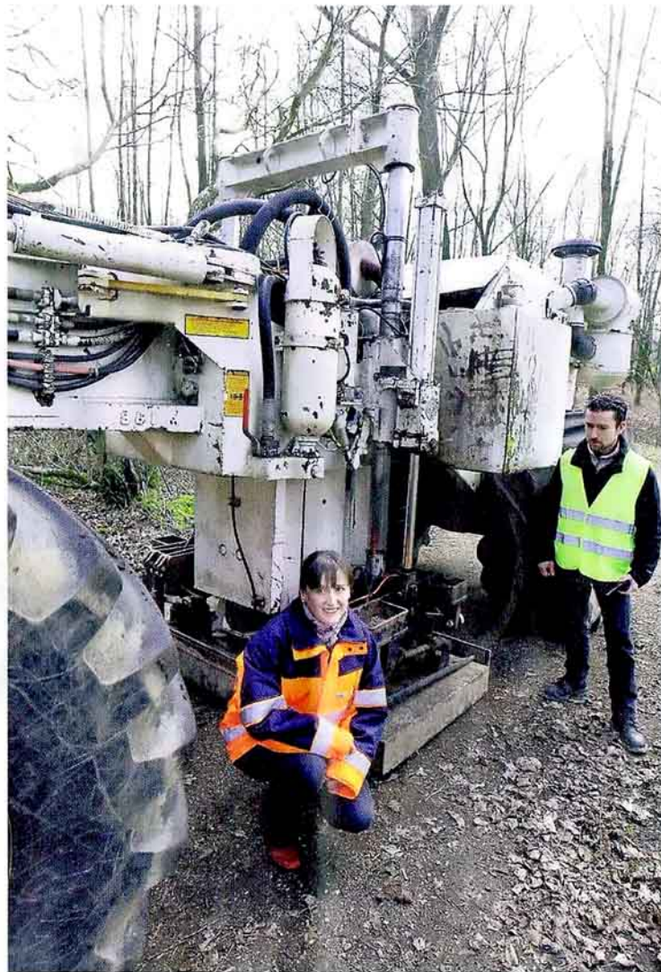
Am Philosophenweg in Xanten stand gestern das Spezialfahrzeug mit der Rüttelplatte, um Salzlagerstätten zu erkunden. RP-FOTO: ARMIN FISCHER
