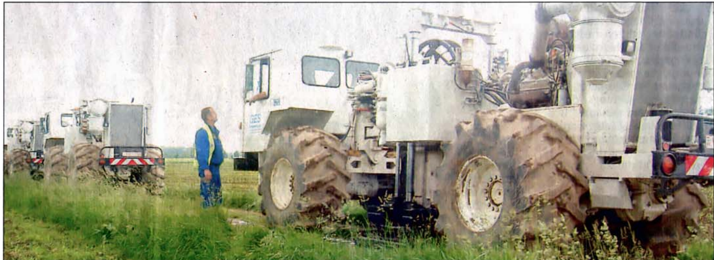
Mit diesen Vibrationsfahrzeugen wird bis in 3000 Metern Tiefe gemessen.
