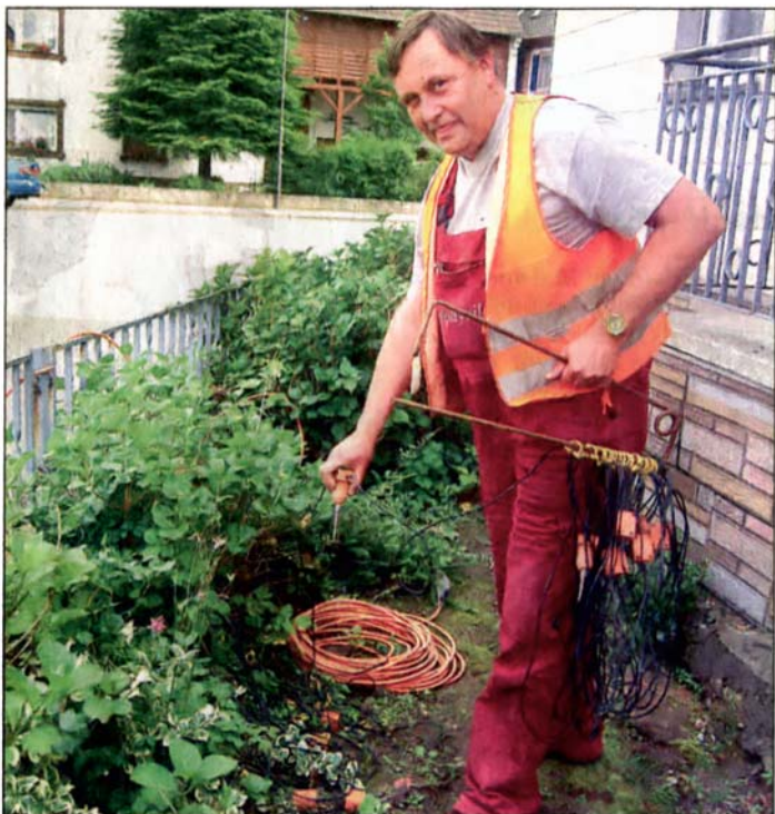
Jens Urban bei der Anbringung der Erdmikrophone (Geophone).
