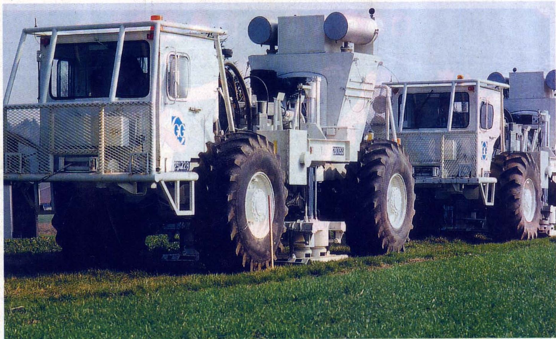
Mit solchen Vibrator-Fahrzeugen wurden beim Dekorp-Projekt Schallwellen in den Untergrund geschickt, deren Rücklaufsignale auf die Beschaffenheit der Erdkruste schließen lassen. Foto: web
