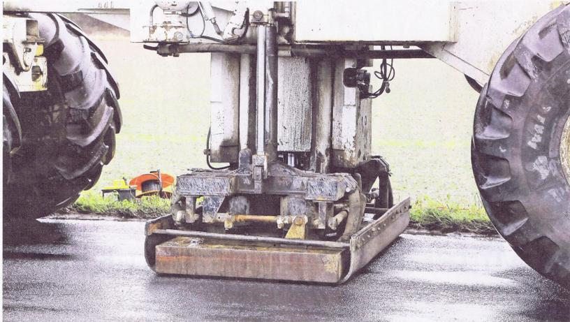
Grobmotorische Sensendation: Mit dieser „Rüttelplatte“ schicken die Geophysiker – wie hier an der Kreisstraße 14 zwischen Ossenberg und Borth – Schallschwingungen in die Tiefe. Die werden von den Erdformationen reflektiert und geben Aufschluss darüber, wie's unter Tage aussieht.
